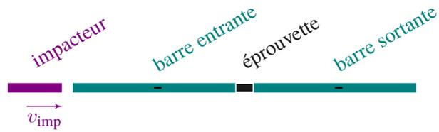
FIGURE 1 – Schéma de principe des barres de Hopkinson
