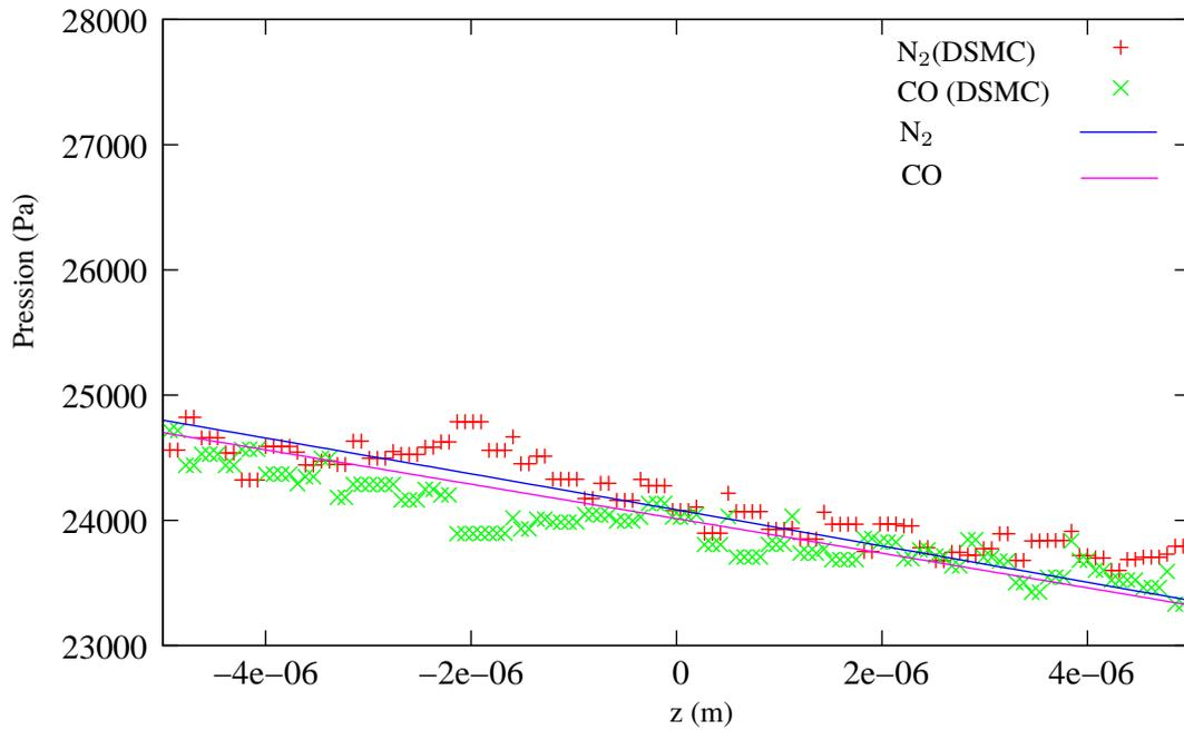
FIGURE 1 – Pression (Pa) le long de l'axe du micro-canal - comparaison avec DSMC ( $\bar{Q}_{ma} = 1.866 \cdot 10^{-13} \text{ kg}\cdot\text{m}^{-1}\cdot\text{s}^{-1}$  and  $\bar{Q}_{mb} = 1.845 \cdot 10^{-13} \text{ kg}\cdot\text{m}^{-1}\cdot\text{s}^{-1}$ )
