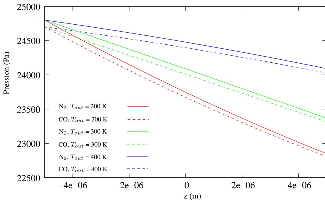
FIGURE 2 – Pression (Pa) le long de l'axe du canal pour une température d'entrée  $T_{in} = 300 \text{ K}$  et différentes valeurs pour la température de sortie  $T_{out}$  ( $\bar{Q}_{ma} = 1.866 \cdot 10^{-13} \text{ kg}\cdot\text{m}^{-1}\cdot\text{s}^{-1}$  and  $\bar{Q}_{mb} = 1.845 \cdot 10^{-13} \text{ kg}\cdot\text{m}^{-1}\cdot\text{s}^{-1}$ )
