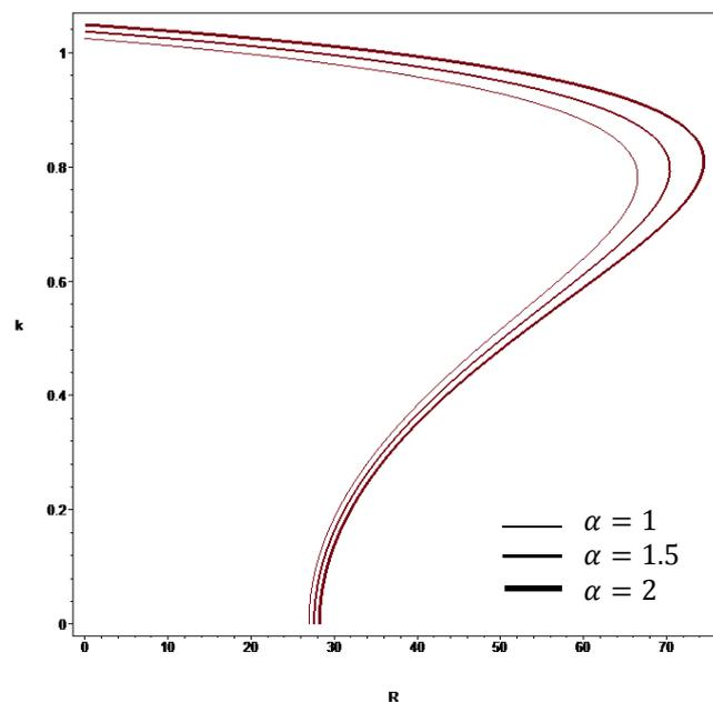
FIG. 2 – Courbes de stabilité neutre avec  $Ha = 0.5, R_a = 2, Fr = 1, W = 10/(R_a R)$
