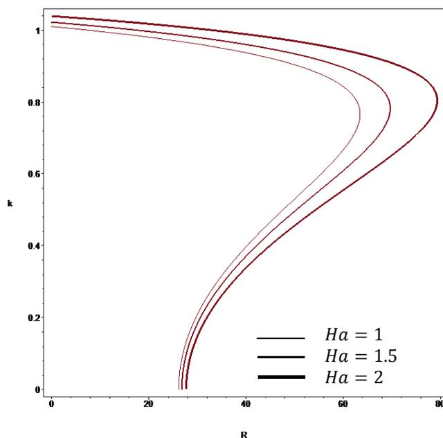
FIG. 1 – Courbes de stabilité neutre avec  $\alpha = 0.1, R_a = 2, Fr = 1, W = 10/(R_a R)$
