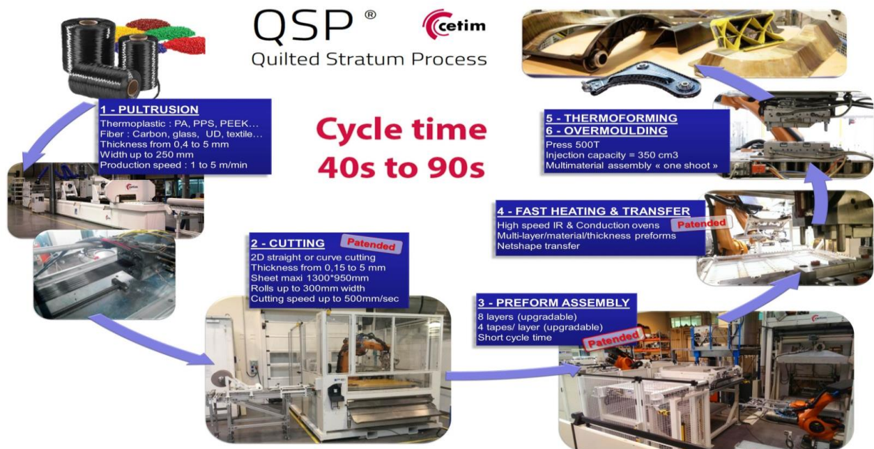
Figure 3 : Description de la ligne pilote QSP du CETIM
