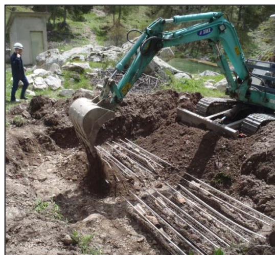
Photo 1. Illustration du dispositif expérimental de Castérino lors du déterrage des échantillons de racines ligneuses après 4 ans de décomposition
