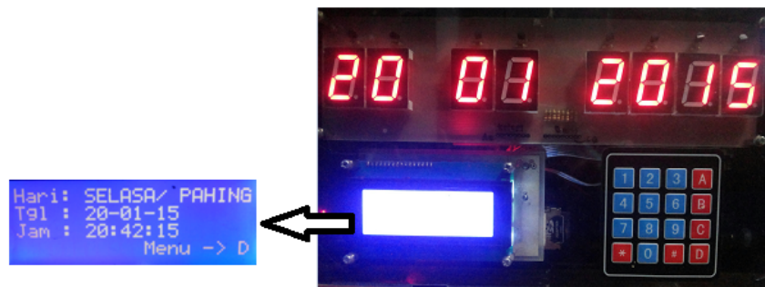
Gambar 16. Pengujian Sistem Minimum ATmega128 dan LCD
