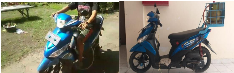
Uji jalan bahan bakar gas LPG dan pertalite Bentuk kendaraan dual fuel
