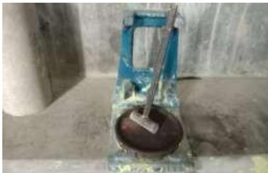
11. Alat Cetakan Capping Beton
