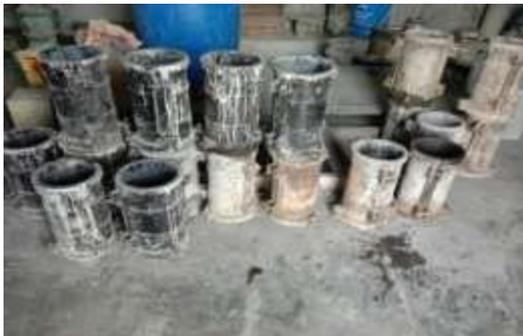
9. Cetakan Silinder Beton
