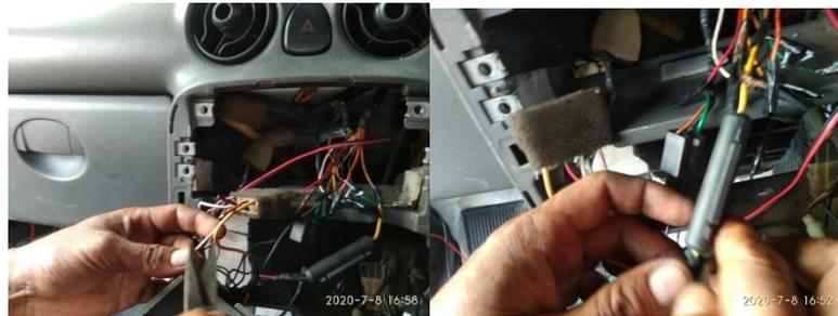
Gambar 3.4 Proses instalasi kabel pada Head Unit
