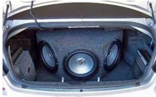
Gambar 2.10 Pemasangan Subwoofer pada Bagasi Mobil
