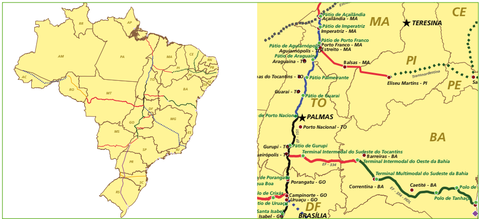
FIGURA 6 Traçado da Ferrovia Norte-Sul
