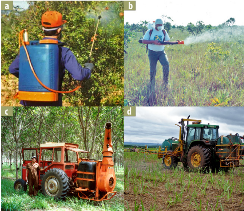
Figura 15. Tipos de pulverizadores. (A) Costal manual; (B) Costal motorizado; (C) Atomizador tratorizado; (D) Pulverizador de barras tratorizado .
