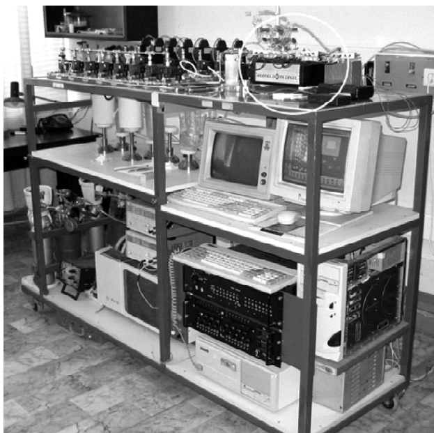
2 pav. Laboratorinė sistema dirbtinei atmosferai bandymų kameroje sukurti, sujungta su elektroninės nosies modulių (pažymėtas apskritimu)
