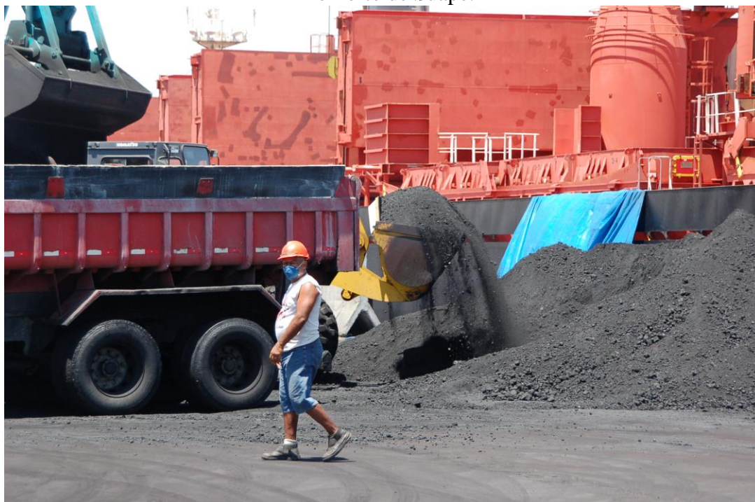
Figura 9. Carregamento de navio com o coque de petróleo, dispersão do pó no entorno no Porto de Suape.
