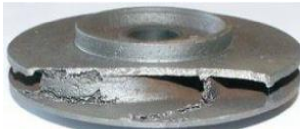
Figura 15. Impulsor dañado. Recuperado de
