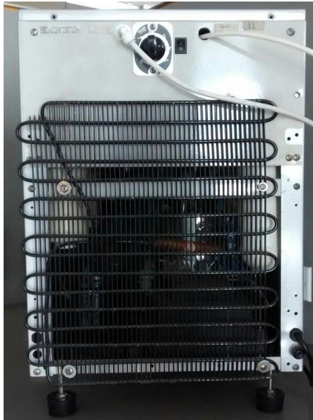
Figura 35. Condensador de un dispensador de agua. Fuente: Elaboración propia
