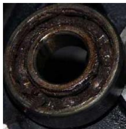
Figura 14. Rodamiento dañado. Recuperado de http://tesis.pucp.edu.pe/repositorio/bitstream/handle/123456789/4783/BARBOZA ANDE RSON SISTEMA FALLAS BOMBA CENTRIFUGA.pdf?sequence=1
