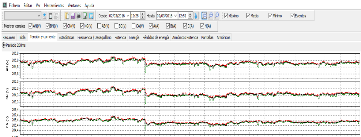
Figura 72. Medición de Tensión, (Torre norte), de 12:29 pm a 12:51 pm. Analizador de redes Fluke 434-II. Fuente: Elaboración propia.
