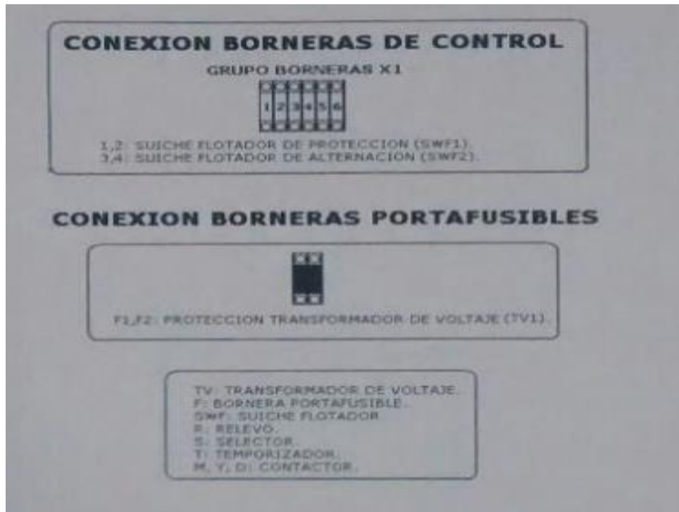
Figura 68. Conexiones borneras de control y borneras portafusibles. Fuente: (Ortega, 2016).
