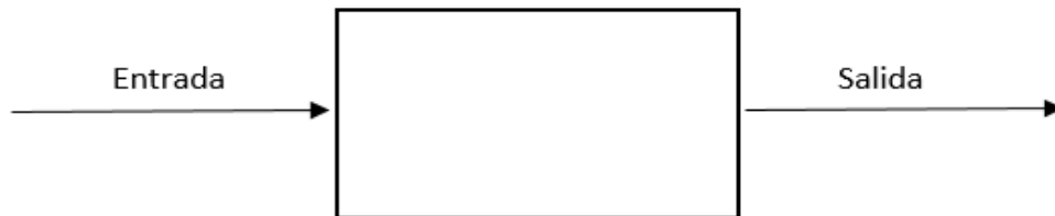
Figura 27. Bloque de Transferencia simple de un sistema de control. Fuente: Elaboración propia.
