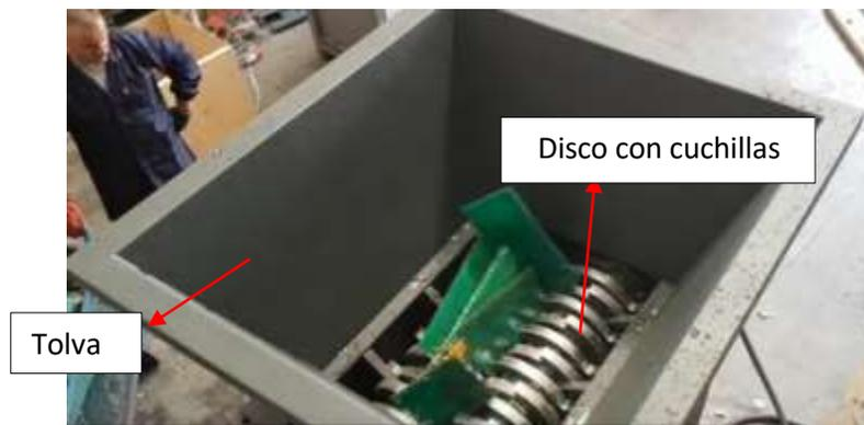
Figura 24. Molino triturador de disco en forma de estrella (CMBE, 2016).
