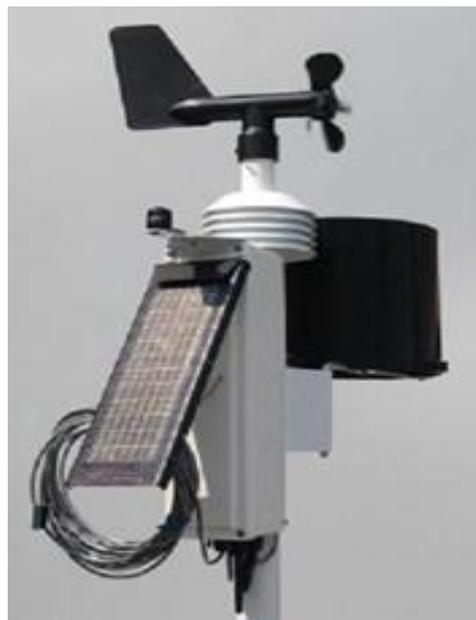
Fig. 1. Estación meteorológica PVMET-300 utilizada en la toma de datos.
