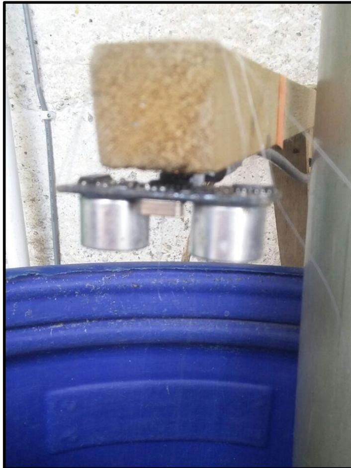
Figura 14. Sensor de ultrasonido utilizado en el sistema. Fuente: Autor
