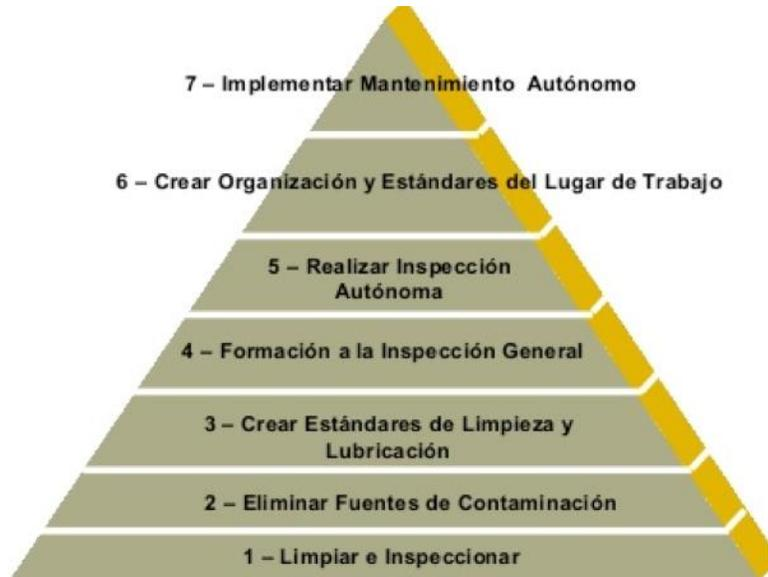
**FIGURA 3. PASOS DEL MANTENIMIENTO AUTÓNOMO**
