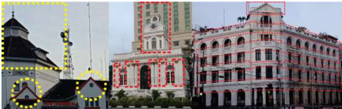
Gambar 4. Ciri – Ciri Umum Dan Penonjolan Bidang Dinding Bangunan Berkarakter Kolonial Di Kawasan Lapangan Merdeka
