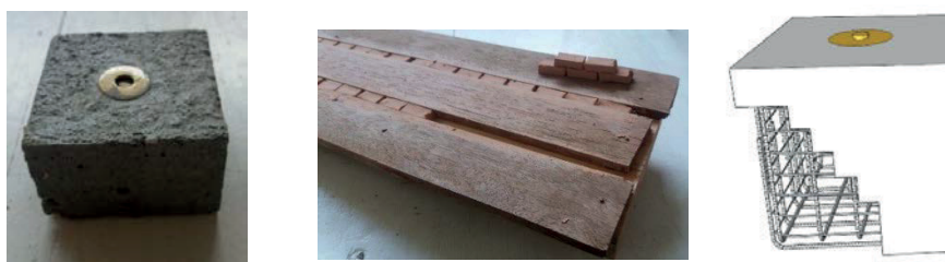
Figura 2. (À Esq.): Bloco de fundação produzida em concreto com inserção de botão imantado para montagem e desmontagem
