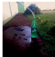
Figuras 1 e 2 (acoplamento no equipamento climatizador e captação da água para quantificação de volume)
