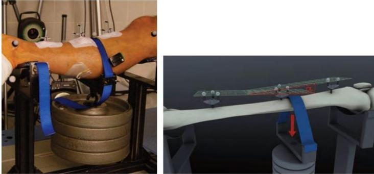
Abb. 12: Dreipunkt-Biegeversuch *in vivo* mit MoCap. Links Aufnahme während der *in vivo* Studie. Rechts digitale Rekonstruktion zur Veranschaulichung (Quelle: [51])
