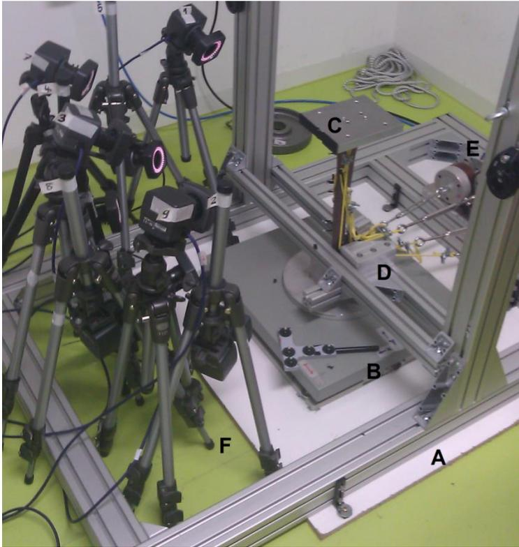
Abb. 21: AMBR Version 2 Layout: (A) ITEM Strukturrahmen und Grundplatte, (B) Kraftmessplatte, (C) Testaufbau des künstlichen Knochens, (D) System zur Kraftumlenkung, (E) Aktuator-Plattform inklusive Kraftmessdosen, (F) MoCap Kameras [101]
