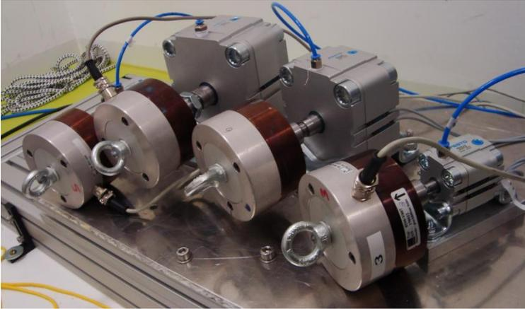
Abb. 24: Pneumatische Aktuatoren mit montierten Kraftmessdosen. Von links nach rechts: (D) FDL, (A) Soleus, (B) TibPos, (C) TibAnt. (Quelle: [99])
