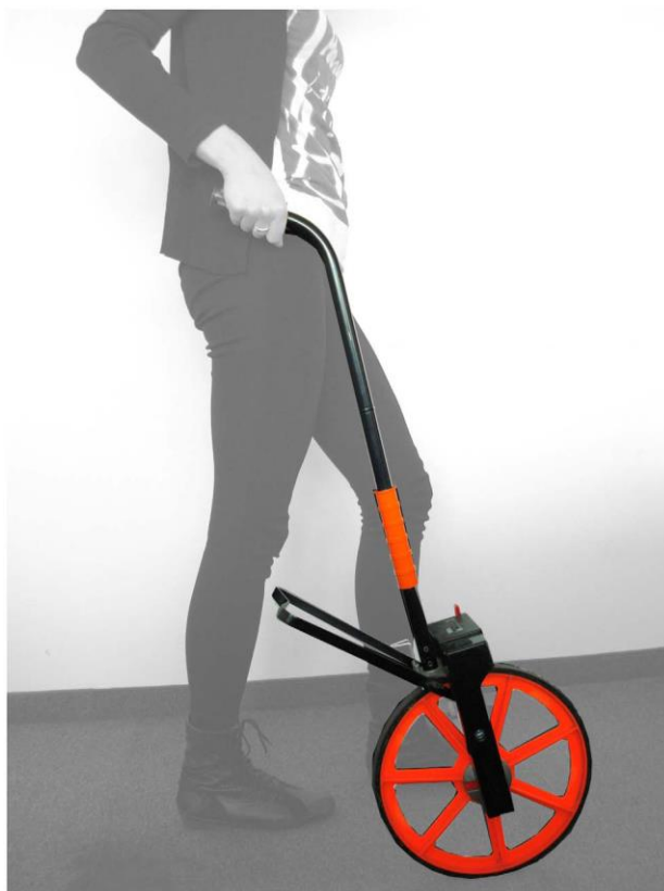
Abbildung 10: Mobiler Goldstandard - Geologisches Messrad zur Bestimmung der Gehstrecke des 1mwt
