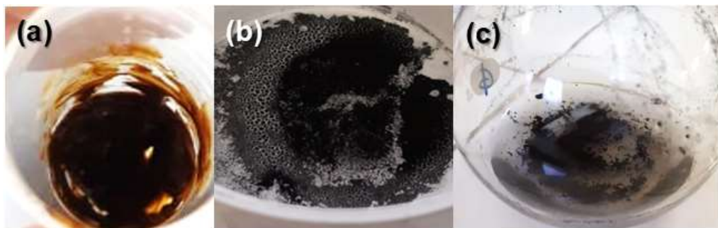
Figura 24. (a) GO obtenido después de lavar y centrifugar, (b) RGO después de filtrar y lavar, (c) precipitación del RGO al terminar la reducción.
