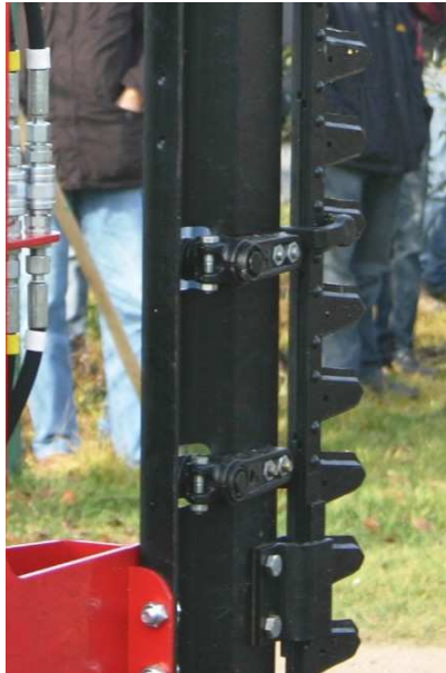
Abbildung 7: Doppelmesserschneidwerk des Mähbalkens
