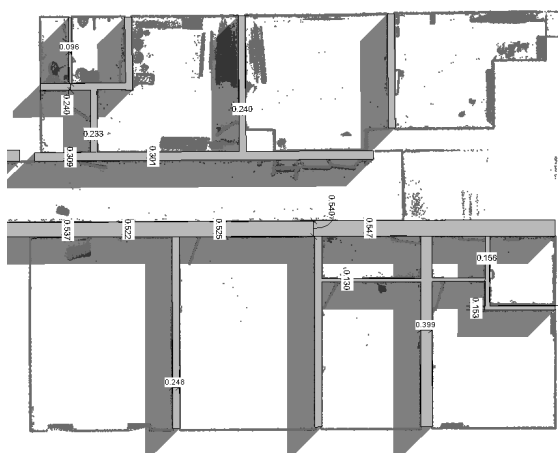
FIGURA 22: corte horizontal longitudinal del sótano después de dibujar los muros. Se ha exagerado la sombra para facilitar su identificación.
