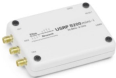
Figure 10 Ettus B205 Mini SDR
