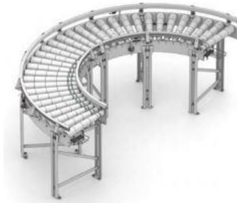
Figura 4-19 Transportador de Rodillos de Acúmulo en Curva.
