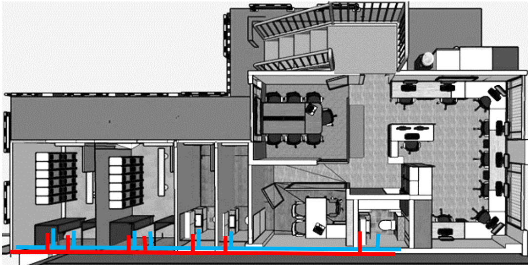
Figura 8-34 Red de derivaciones de la planta baja.
