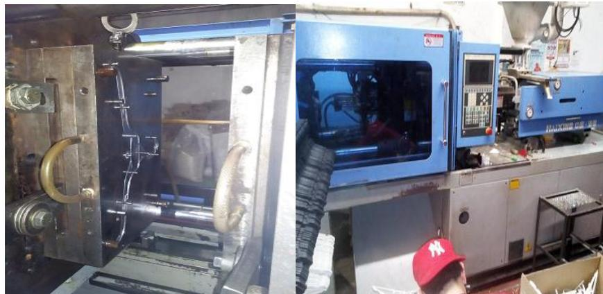
**Molde listo esperando en la maquina e Inicia proceso de inyección**
