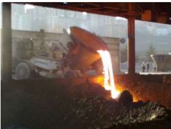
Figura 80: Detalle del vertido de la escoria en la piscina
