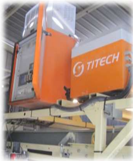
Figura 66. Sistema de separación automática por infrarrojos (separación de yesos y metales en el proceso de reciclaje de RCD)
