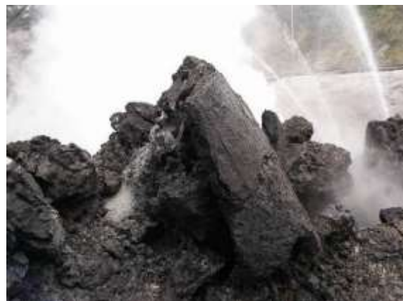
Figura 81: Detalle del proceso de enfriamiento de la escoria negra
