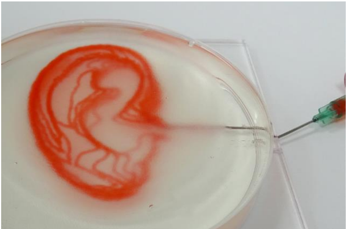
Slika 2.3: Pretočne strukture natisnjene s prototipom VITAPRINT (vir: arhiv podjetja IRNAS)
