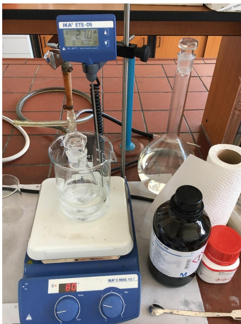
Slika 3-4 Postopek sinteze globoko evtektičnega topila
