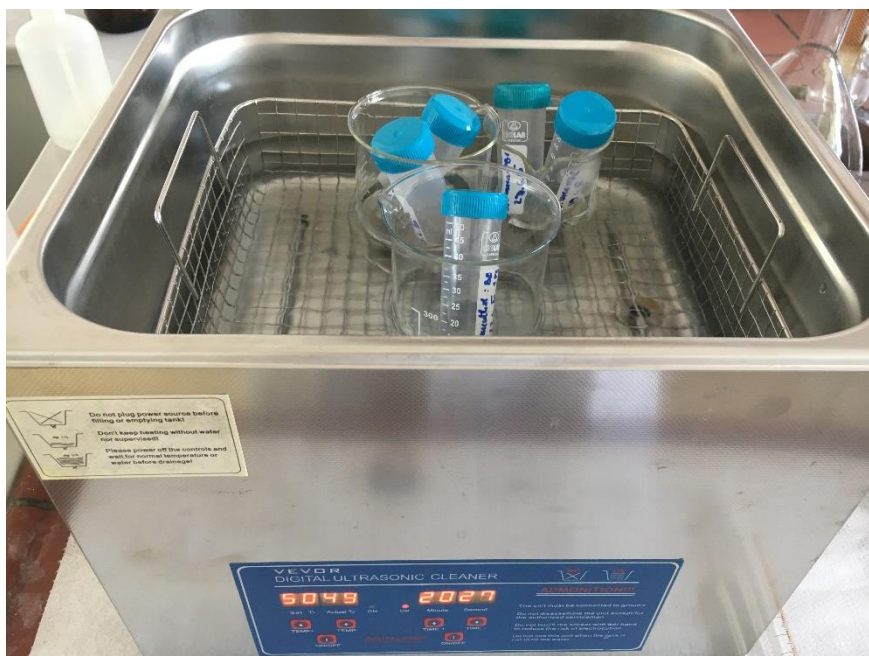
Slika 3-1 Ekstrakcija aktivnih komponent iz pegastega badlja s pripravljenimi DES topili v ultrazvočni kopeli
