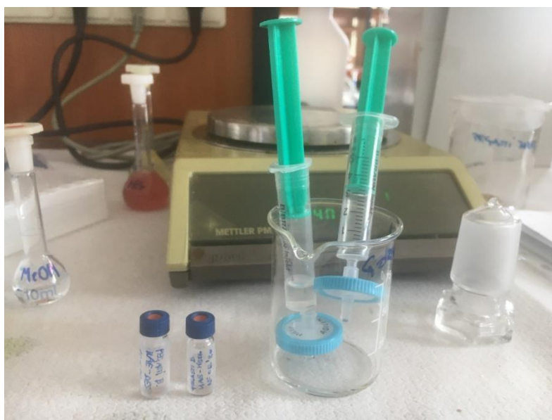
Slika 3-3 Vzorci v vialah, prefiltrirani skozi PTFE filtre, pripravljene za HPLC analizo
