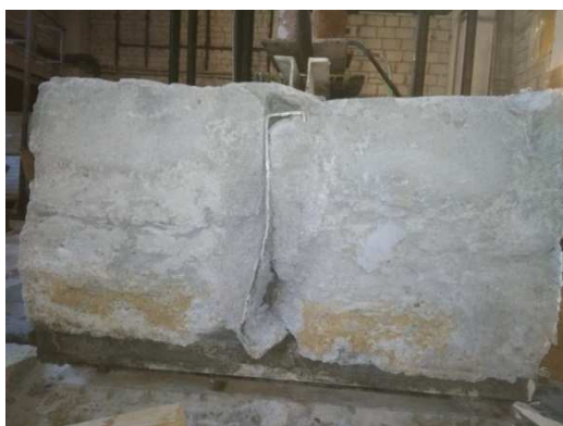
Рисунок 5. – Характер разрушения образцов в опорной зоне
