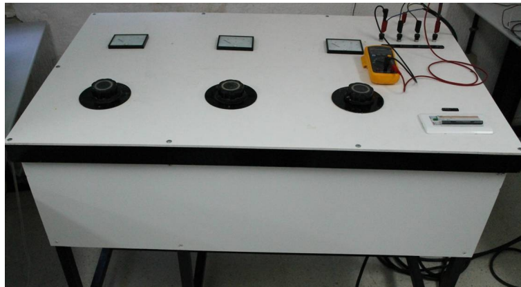
Figura B.4. Fuente de alimentación a través de autotransformador regulable.
