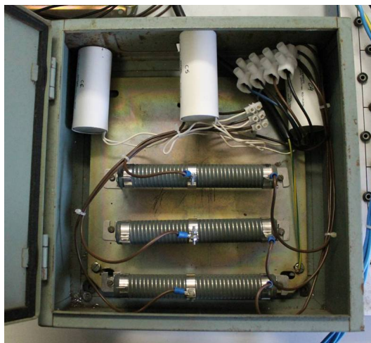
Figura B.10. Ramas R_P C_P para el filtro activo serie - paralelo.
