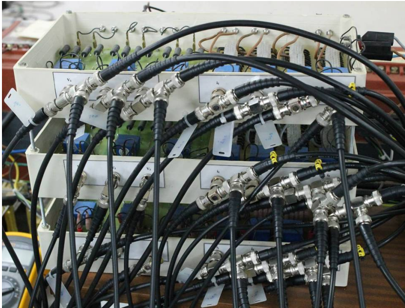
Figura B.16. Agrupación de sensores LEM para el conjunto de medidas de la plataforma.
