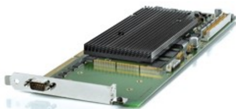
Figura B.38. Tarjeta de control PPC 1005 de dSPACE.
