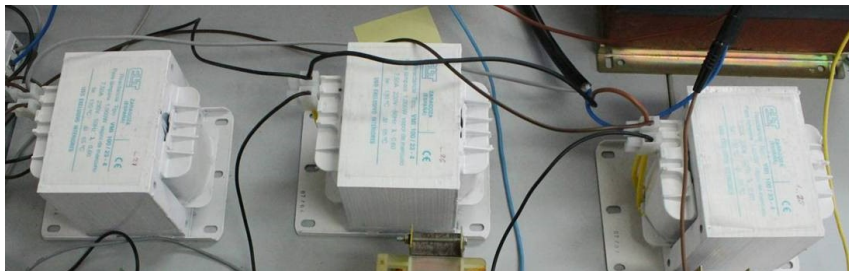
Figura B.9. Inductancias L_P del convertidor paralelo.
