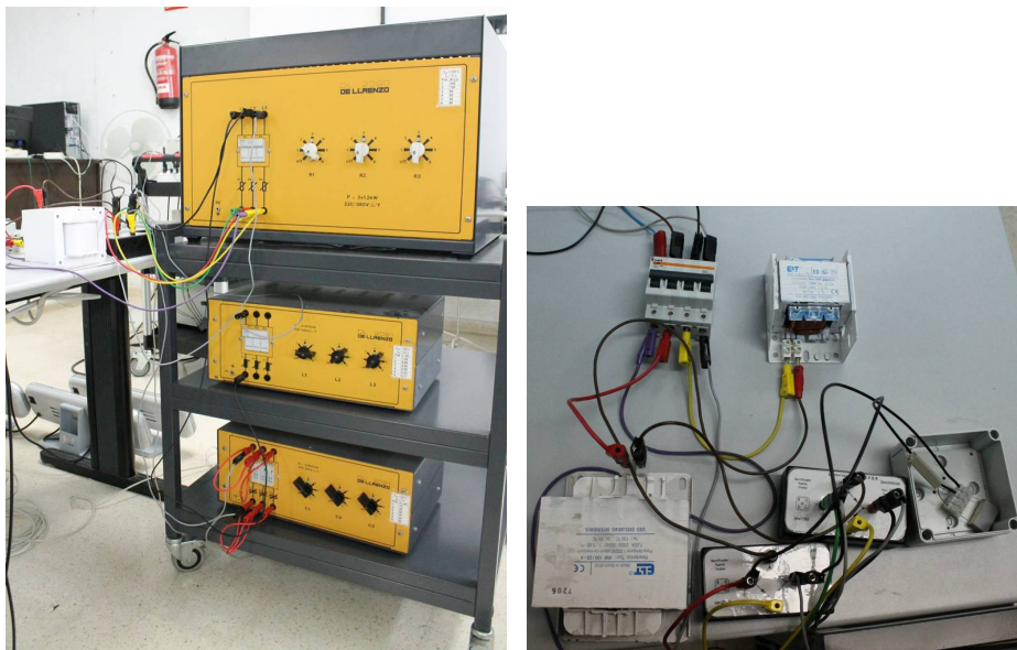
Figura B.5. Carga trifásica desequilibrada no lineal, de cuatro hilos.
