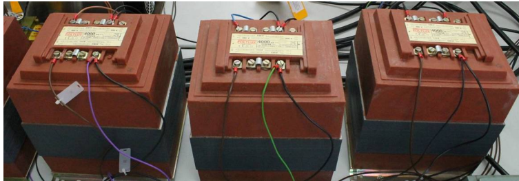
Figura B.11. Transformadores de acoplamiento serie T_S .
