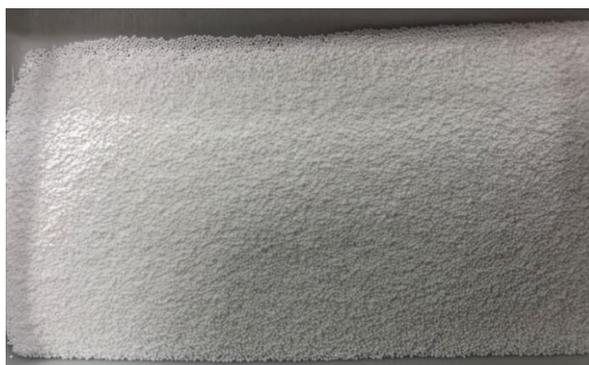
Figura 9. Muestra de alúmina empleada en los catalizadores.
