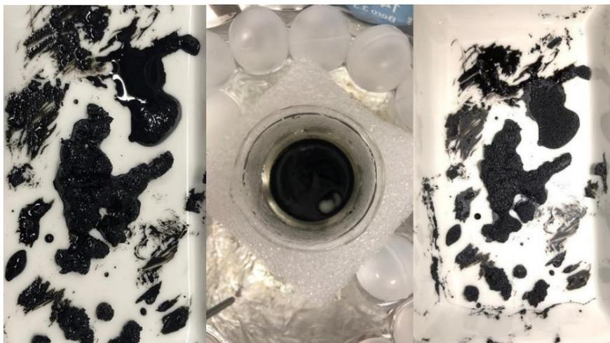
Figura 12. Estado de las muestras previo y posterior al secado tras la impregnación húmeda.
