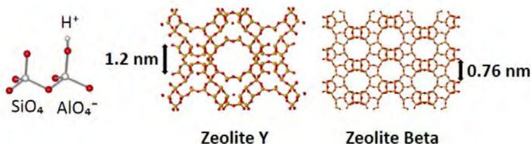
Figura II.14: Estructura de zeolita Y y Beta.
