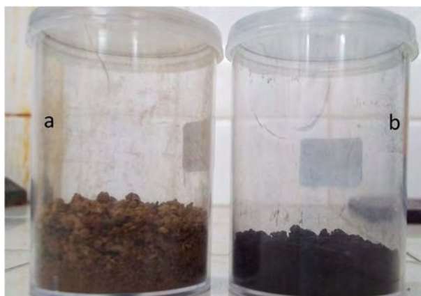
Figura III.7: Material carbonoso con template de SiO 2 antes (a) y después (b) del tratamiento de carbonización.
