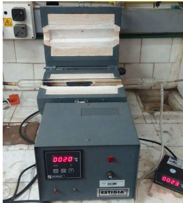
Figura III.4: Horno y reactor de vidrio utilizado para carbonización de los distintos materiales.
