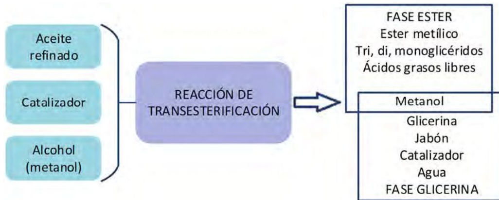
Figura I.19: Fases de la reacción de transesterificación.
