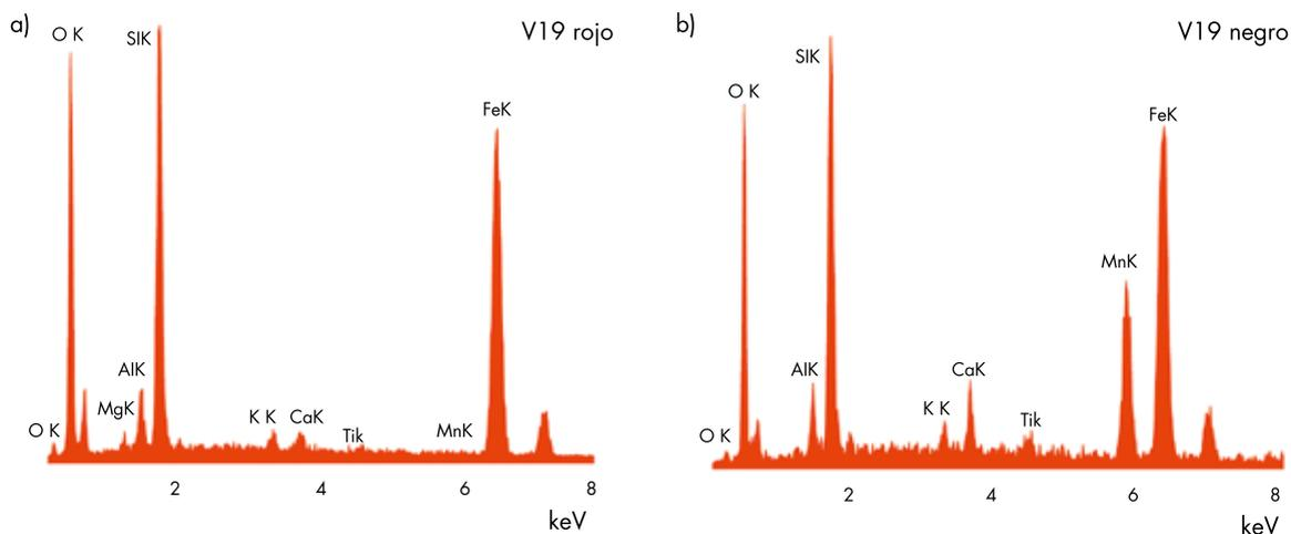
Figura 5. Composición elemental obtenida por SEM-EDS de dos puntos de la muestra V19: a) zona roja; b) zona negra.
