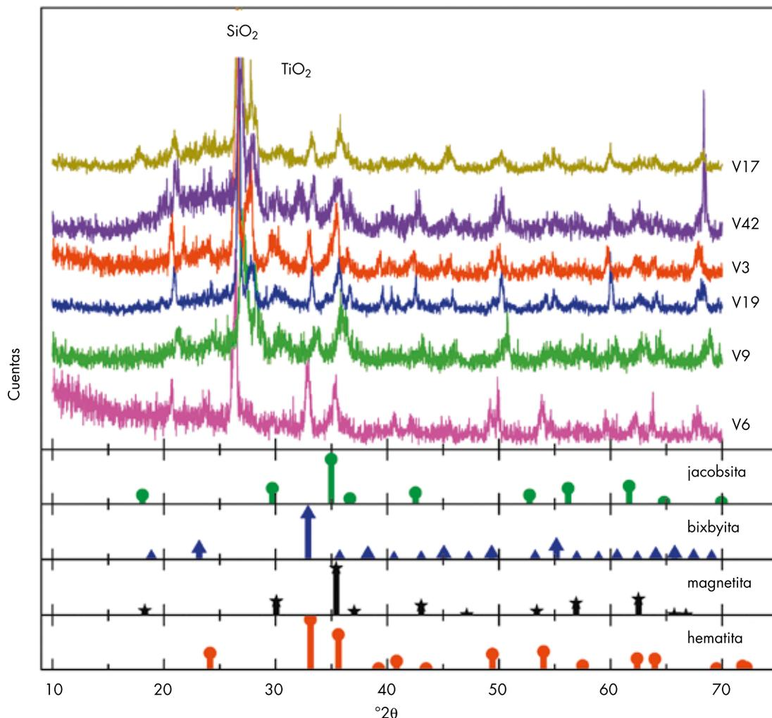
Figura 6. Difractogramas de rayos X de las muestras analizadas y de los patrones de jacobita (PDF#00-010-0319), bixbyita (PDF#00-010-0069), magnetita (PDF#01-076-1849) y hematita (PDF#00-024-0072).
