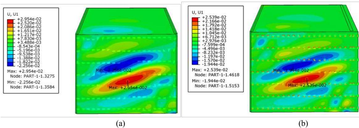
Figura 23: Modelo M1 con correas separadas 0.6m, desplazamientos en (m), (a) Tipo C3, (b) Tipo C4.
