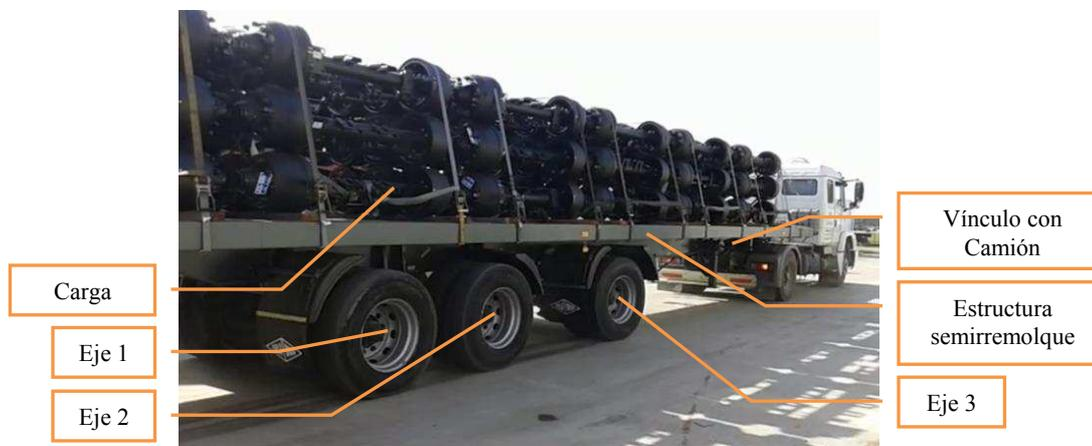
Figura 1: Prototipo de semirremolque 2+1.
