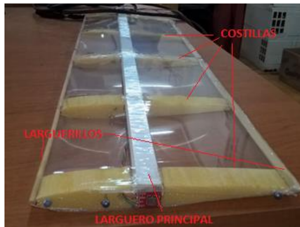
Figura 7. Configuración del ala con el larguero al 40% de la cuerda.
