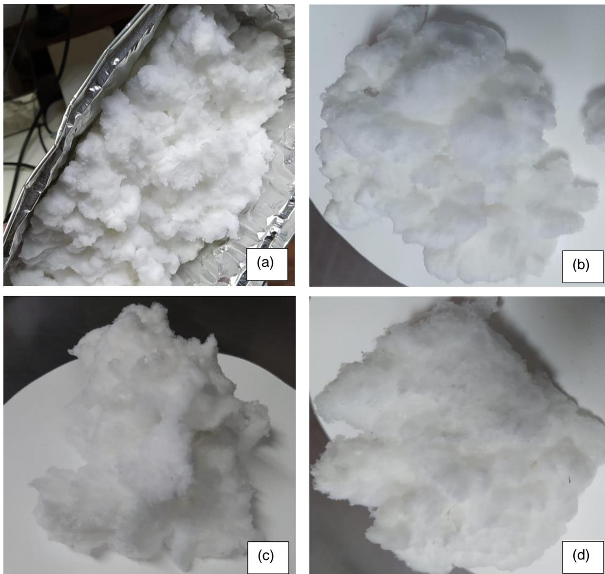
*Figura 4.2 - Pastas desfibradas a seco num moinho de martelos a uma velocidade de rotação de 3500 rpm: (a) Pasta controlo, (b) Pasta modificada com uma dosagem de 1,0 kg/tpsa do SC2, (c) Pasta modificada com uma dosagem de 2,5 kg/tpsa do SC2 e (d) Pasta modificada com uma dosagem de 4,0 kg/tpsa do SC2.*
