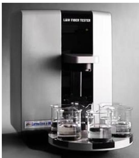
Figura 3.2 - Equipamento utilizado para a determinação da morfologia das fibras – L&W FiberTester Plus.
