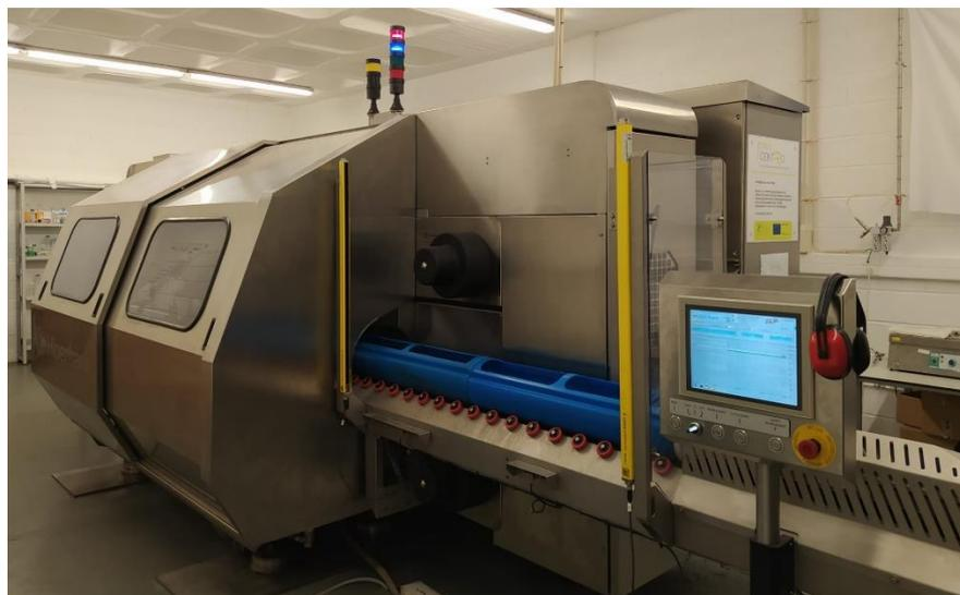
Figura 3.1 – Equipamento de alta pressão usado (*Hiperbaric model 55*).
