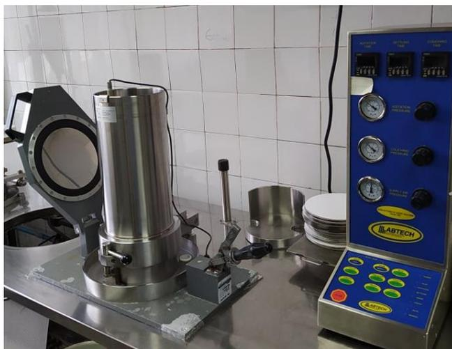
Figura 3.3 – Formador de folhas laboratoriais.
