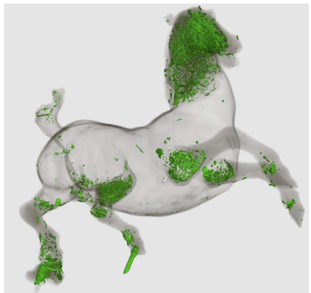
13. ábra. A szobor belsejének neutrontomográfiai leképezése.
