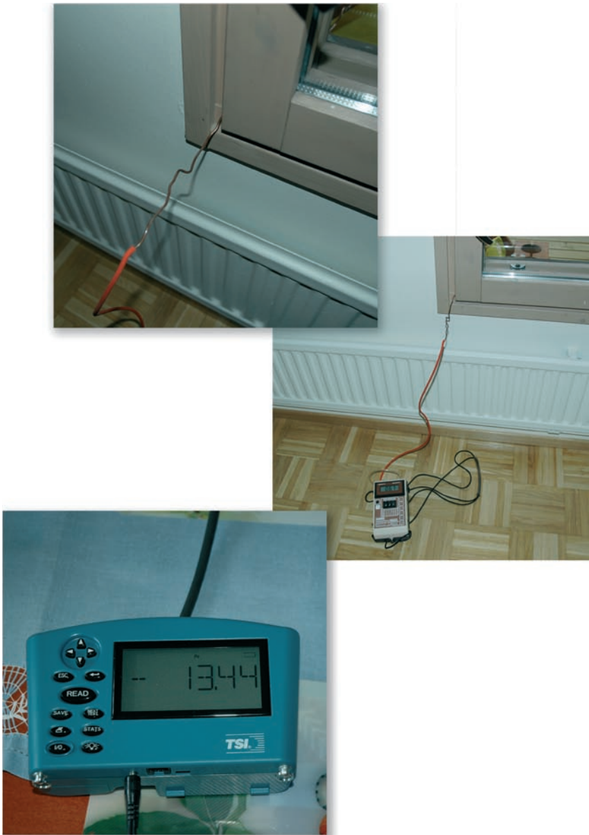
Bild 12.2 Mikromanometer som används för att mäta undertryck. Undertrycket i förhållande till utomhusluften mäts med hjälp av ett tunt rör i fönsterspringan.
