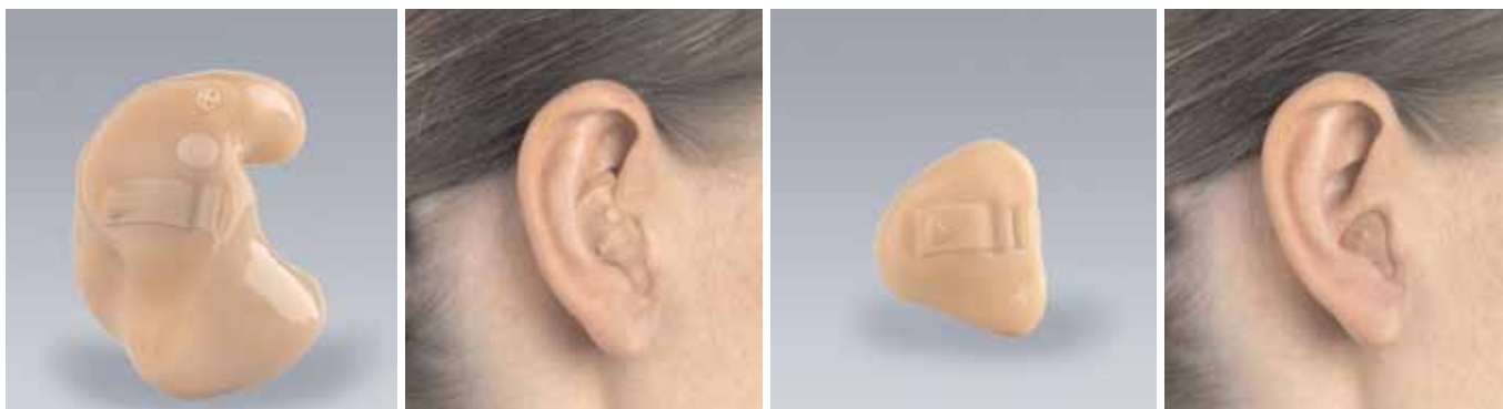
Kuva 2. Esimerkkejä yksilöllisesti valmistetuista korvakäytäväkojeista. Koje on rakennettu korvakappaleen (kuorikon) sisään käyttäjän oman korvan mallin mukaisesti. Konkakoje ylettyy korvalehden kuoppaan (vasemmanpuoliset kuvat). Varsinaista korvakäytäväkojetta pidetään korvakäytävän suulla (oikeanpuoliset kuvat). Erikoistapauksessa koje voi miltei piiloutua korvakäytävään. (Kuulohansan luvalla).
