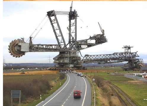
Figura 2.— Alzado de diferentes rotapalas capaces de dar una producción de 3.150 m 3 /h.
