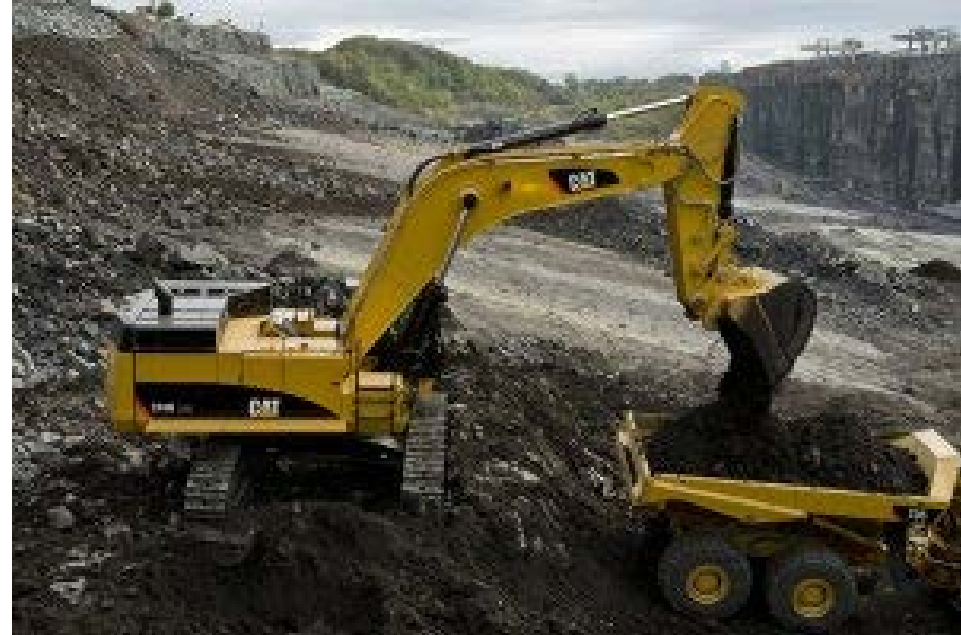
Retroexcavadora - Hydraulic backhoe
