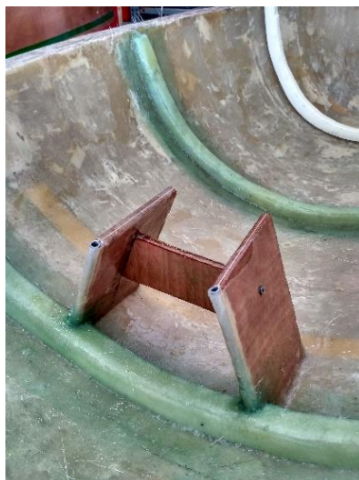
Figura 136. Laminació dels reforços. Font: pròpia.
