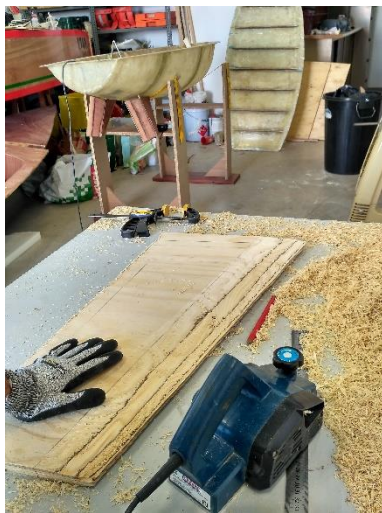
Figura 125. Mecanització del perfil al pla antideriva. Font: pròpia.
