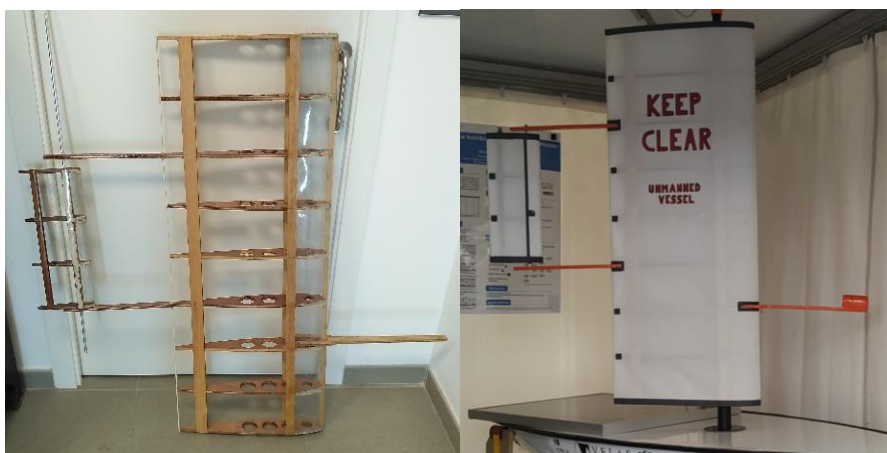
Figura 122. Estructura de l'aparell abans (esquerra) i després (dreta) de la instal·lació del folre. Font: pròpia.
