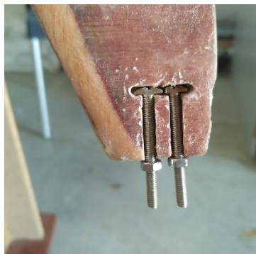
Figura 111. Inserció dels pernys a l'extrem de l'skeg. Font: pròpia.
