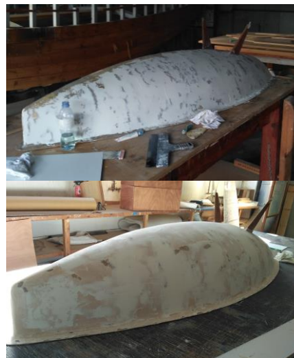
Figura 104. Buc en diferents etapes del procés de massillat. A dalt, anterior; a baix, posterior. Font: pròpia.
