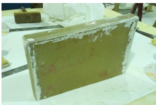
Figura 138. Construcció del calaix de l'orsa. Font: pròpia.
