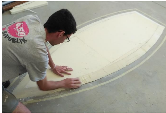
Figura 115. Fabricació del motlle amb poliuretà extruït. Font: pròpia.
