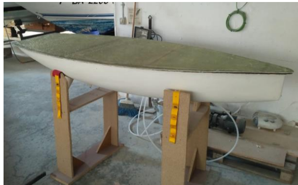
Figura 118. 3r intent de coberta. Formes simplificades i material sandwich. Font: pròpia.
