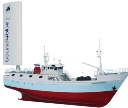
Figura 31. Disseny de vela rígida de l'empresa Bound4blue. Font: [30].
