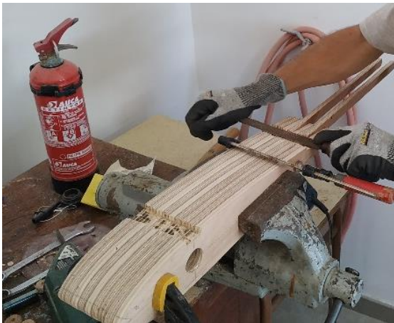
Figura 119. Perfilant els reforços horitzontals de la vela. Font: pròpia.
