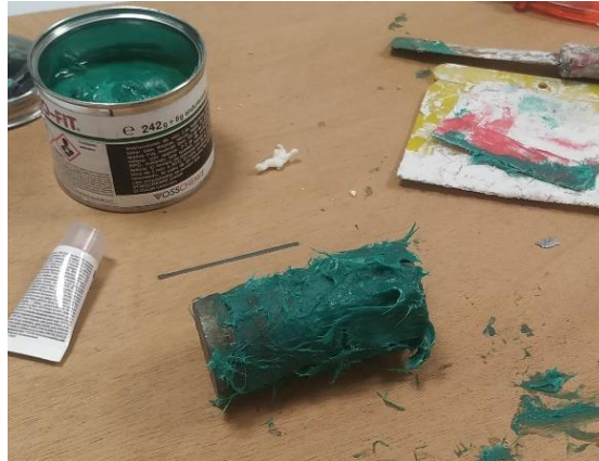
Figura 123. Unió dels medallons amb massilla. Font: pròpia.
