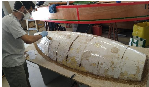
Figura 99. Aplicació de resina de polièster. Font: pròpia.
