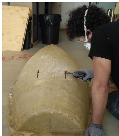
Figura 107. Perforació del buc per muntar els skegs . Font: pròpia.
