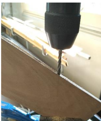
Figura 108. mecanització de la pala del timó. Font: pròpia.
