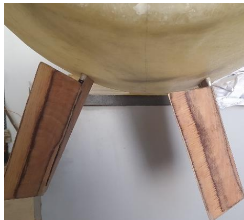
Figura 114. Vista posterior dels timons i skegs. Font: pròpia.
