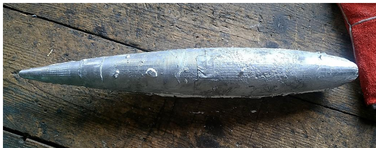
Figura 132. Bulb de plom fabricat a partir de fosa. Font: pròpia.
