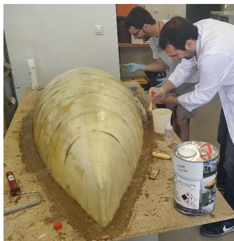
Figura 100. Procés de laminat del buc. Font: pròpia.
