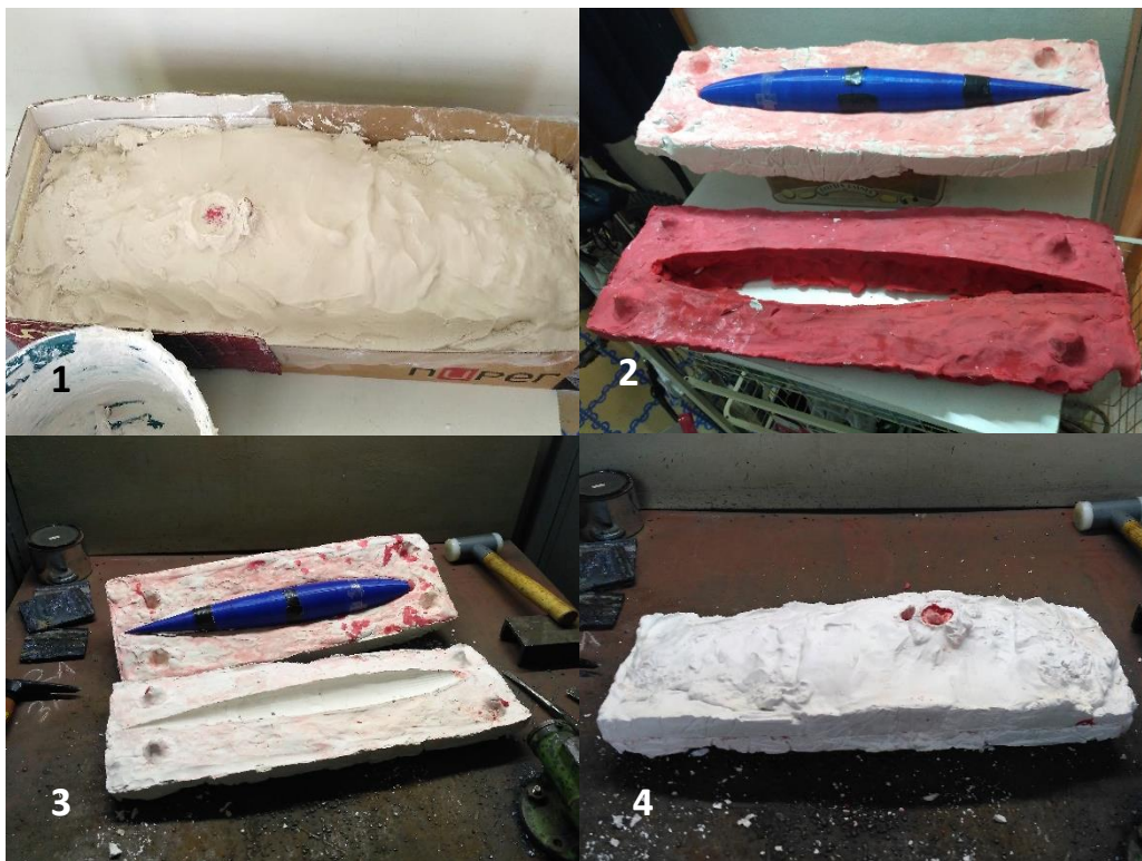
Figura 131. Passos de la construcció del motlle. 1- Elaboració de la 1a part del motlle. 2- Separació del contramotlle de la 1a part. 3- Elaboració de la 2a part calcant el relleu de la 1a. 4- Retirar el model de PLC i tancar el motlle per abocar-hi la fosa de plom. Font: pròpia.
