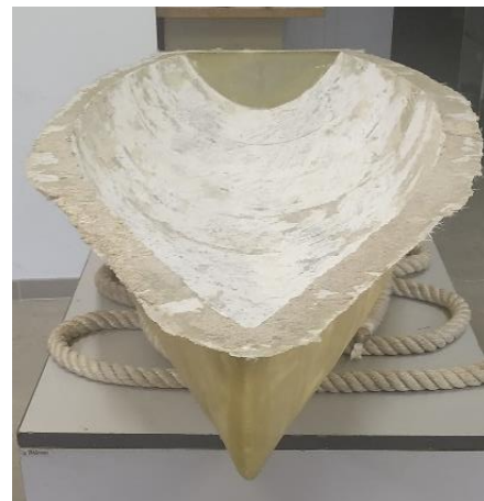
Figura 102. Buc amb restes de l'espuma del motlle a l'interior. Font: pròpia.
