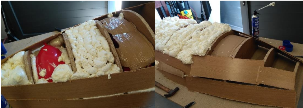
Figura 95. Vistes del procés d'aplicació d'espuma al motlle. Font: pròpia.
