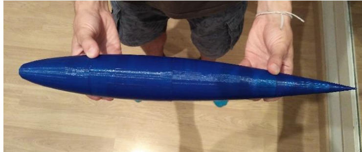
Figura 128. Model del bulb a escala 1:1 fabricat amb impressora 3D. Font: pròpia.
