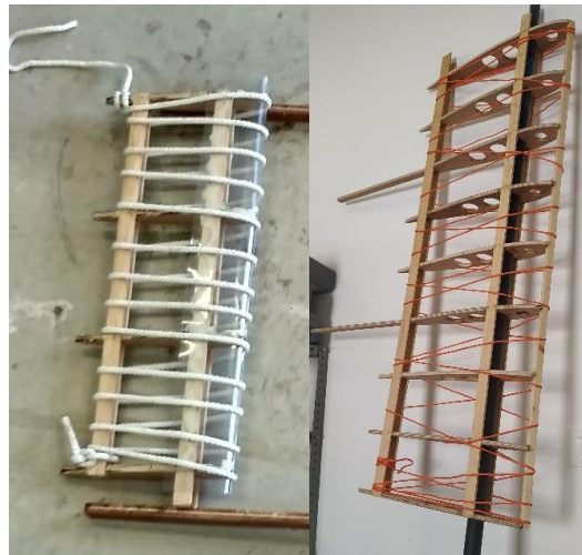
Figura 121. Encolat de les làmines de PVC al costat frontal de l'aleró (esquerra) i la vela (dreta). Font: pròpia.
