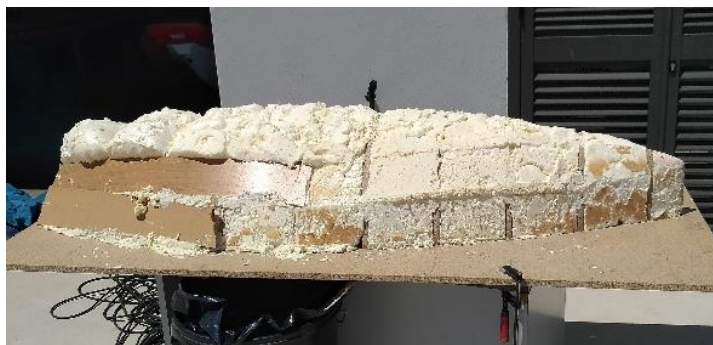
Figura 96. Retirant l'excés d'espuma del motlle. Font: pròpia.
