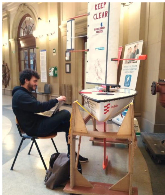
Figura 153. Verificació de les funcions del programa de control al vestíbul de la Facultat de Nàutica de Barcelona. Font: pròpia.
