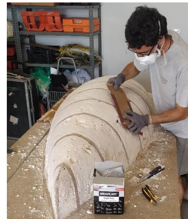
Figura 97. Últimes passades de paper de vidre a l'espuma del motlle. Font: pròpia.
