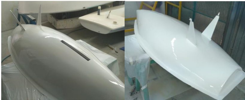
Figura 106. Buc amb pintura aplicada. Font: pròpia.
