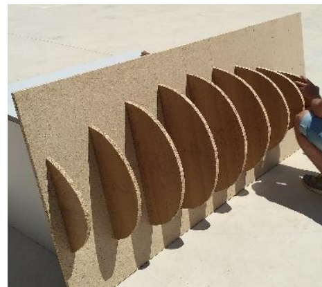
Figura 94. Muntatge de l'esquelet del motlle. Font: pròpia.
