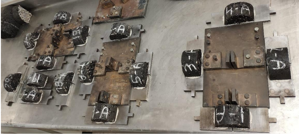
Il·lustració 3.16 – Provetes de Mescla Reciclada enganxades en plaques.
