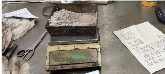
Il·lustració 3.8 – Pesat dels àrids amb balança.
