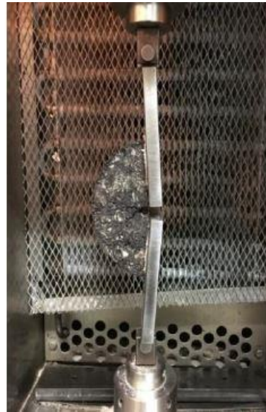
Il·lustració 3.19 – Inici i final de l'assaig Fènix.
