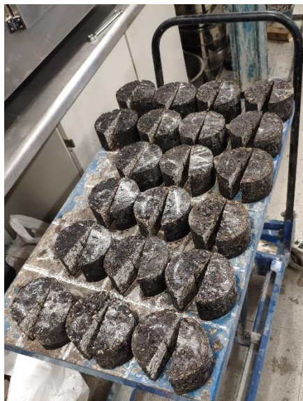
Il·lustració 3.15 – Provetes de Mescla Reciclada tallades.
