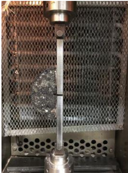
Il·lustració 3.19 – Inici i final de l'assaig Fènix.
