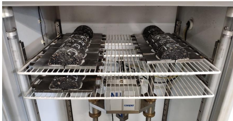
Il·lustració 3.17 – Provetes de Mescla Reciclada en nevera a 20°C.
