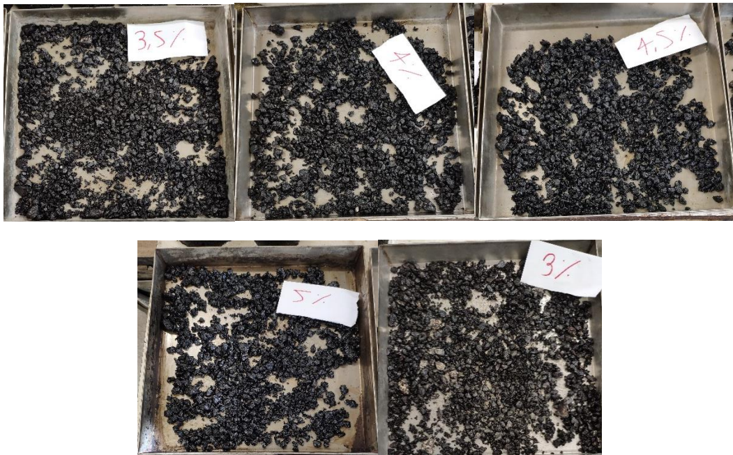
Il·lustració 3.11 – Mostra desgranada Mescla Patró per densitat màxima.
