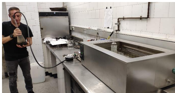
Il·lustració 3.12 – Procés del buit per densitat màxima.
