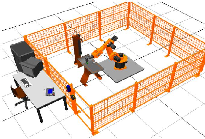
Figura 6.8 – Representación del vallado de seguridad de una célula robotizada
