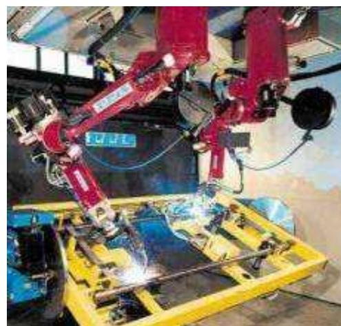
Figura 4.4 – Robot suspendido trabajando en aplicaciones de soldadura
