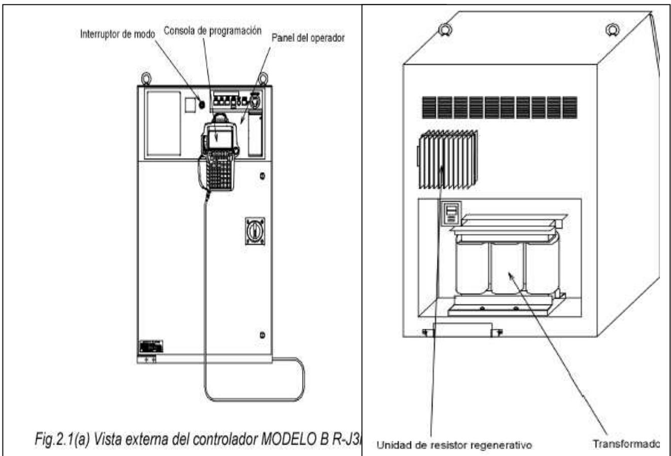
Fig.2.1(c) MODELO B R-J3i vista general del armario B (Parte trasera)
