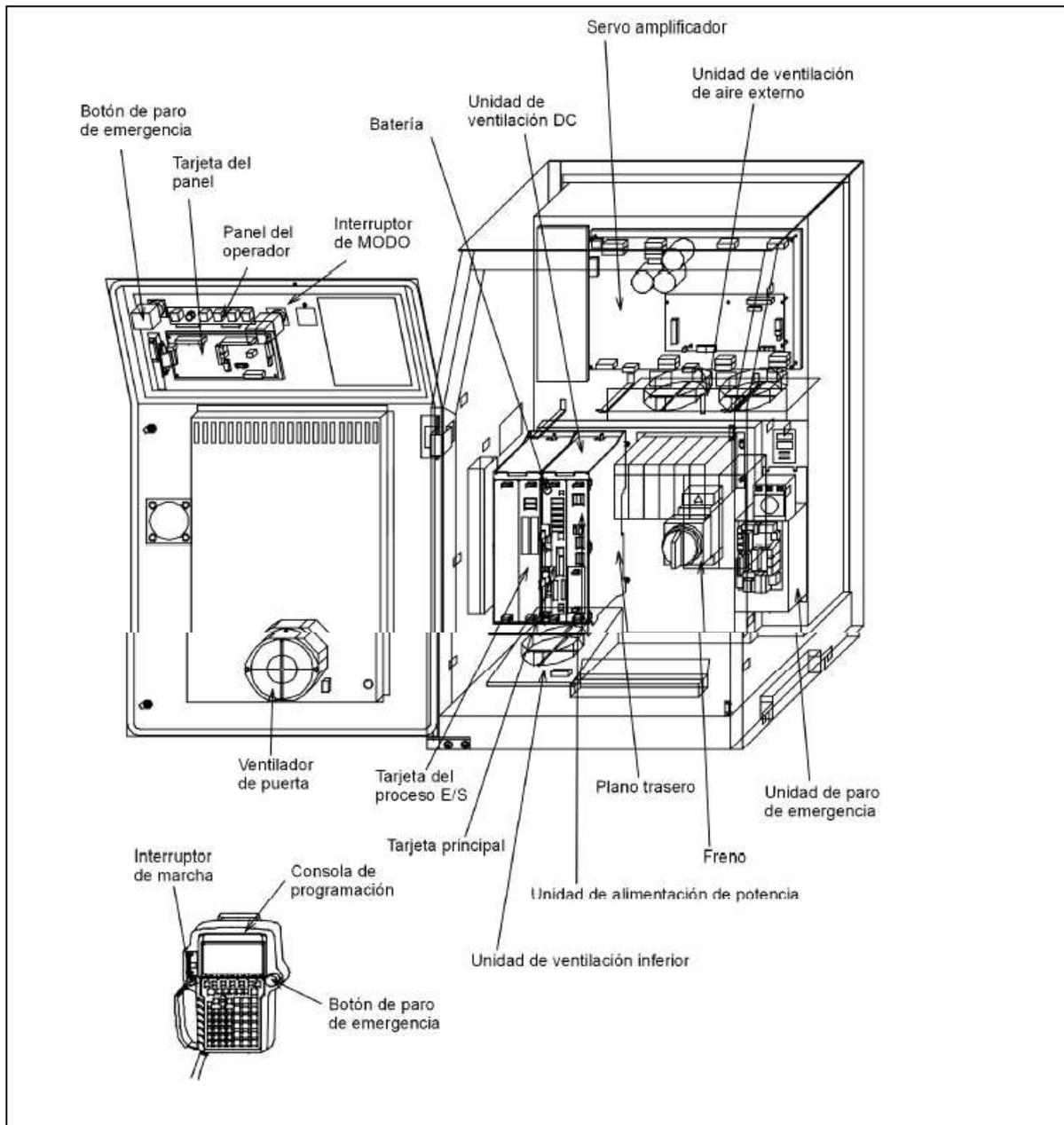
Fig.2.1(b) MODELO B R-J3i interior de armario B (Frente)
