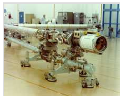
El extremo del Canadarm effector (mástil)
