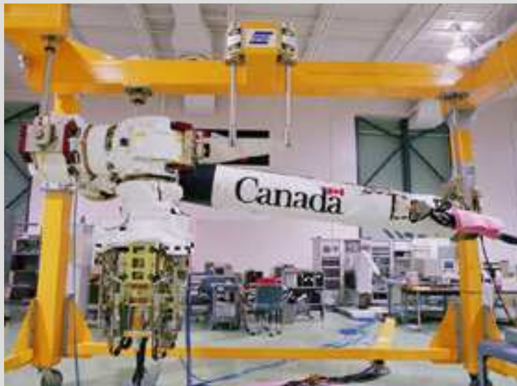
El esqueleto del Canadarm (NASA)
