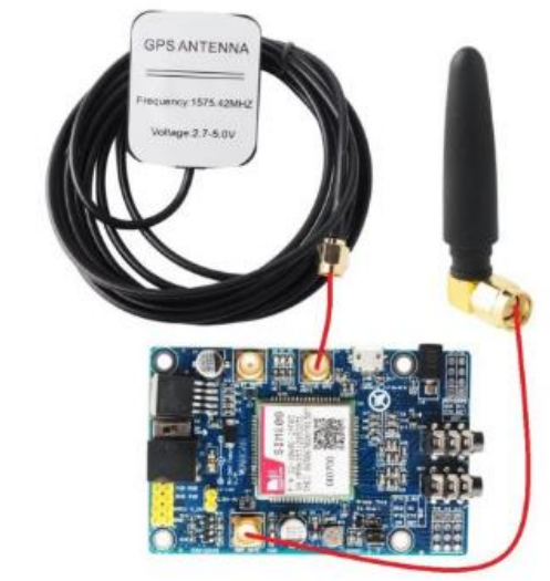
Figura 18. Connexió antenes en el mòdul SIM808
